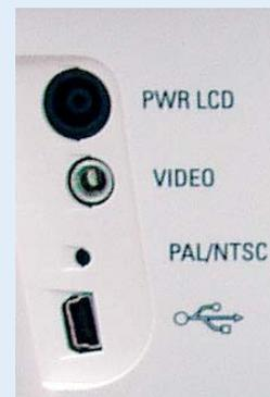
Задняя панель: соединения микроскопа EZ4
