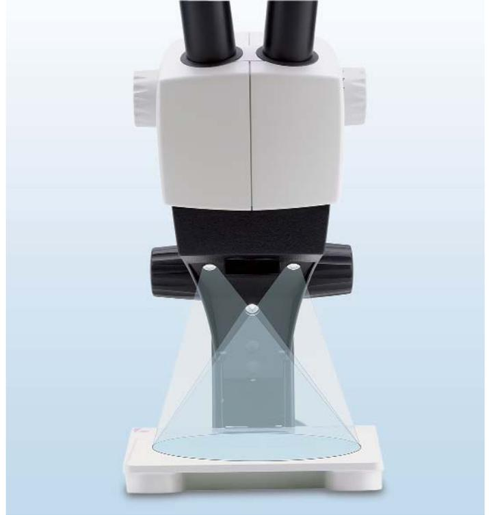
2. Вертикальный падающий свет для обеспечения бестеневого освещения образца.
