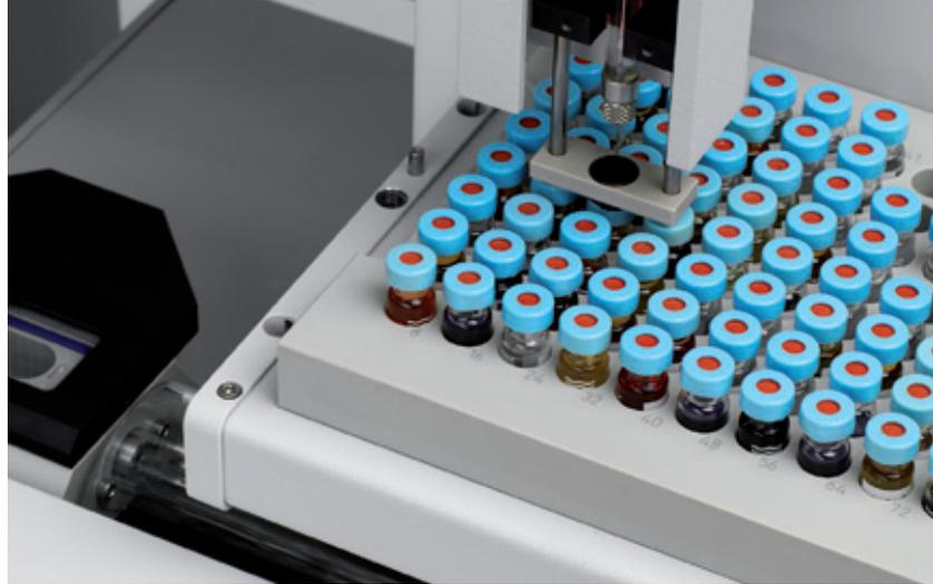
В зависимости от желания заказчика прибор multi EA<sup>®</sup> 5000 может комплектоваться ручной, полуавтоматической или автоматической системой ввода проб.
