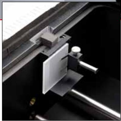
Держатель твёрдых проб для определения характеристик пропускания
