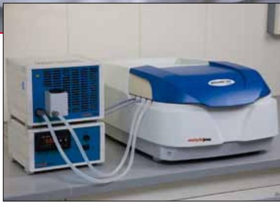
8-позиционный кюветодержатель, термостатируемый элементом Пельтье, для проведения измерений, чувствительных к изменению температуры
