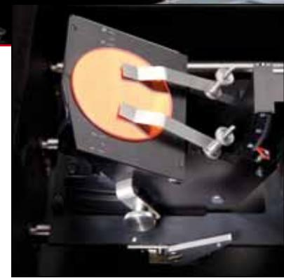
Приставки для определения абсолютного коэффициента отражения с изменяемым углом препомления луча для определения показателя препомления и толщины пленки
